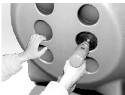
РИСУНОК 1. СВЕРЛЕНИЕ ОТВЕРСТИЯ ДЛЯ УСТАНОВКИ ЗПТ
